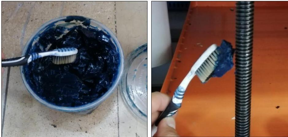
2. Asegurarse de que quede recubierto todo el mecanismo para que no exista oxidación en el mismo.
