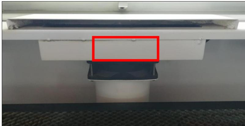
1. Con la ayuda de hexagonales sacar 3 de los 4 tornillos de sujeción del extractor.
