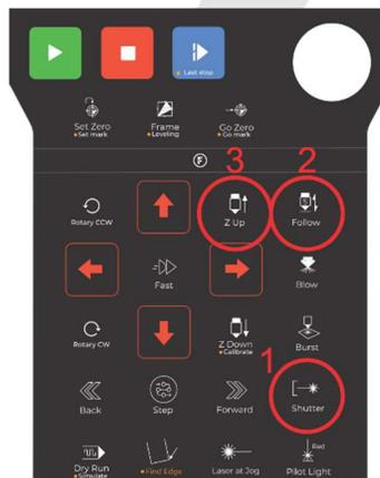
Es importante asegurarse de que el cabezal esté a la altura adecuada para la calibración. De lo contrario, se generará una alarma en el software indicando que la posición no es correcta.
