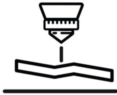
Cabezal automático para trabajo en superficies irregulares, no importa si la plancha está pandeada, el cabezal mantendrá una distancia constante durante todo el corte.
