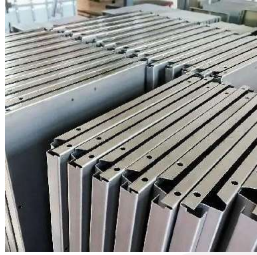
Doblado en aleación Fluor-Aluminio-Zinc
