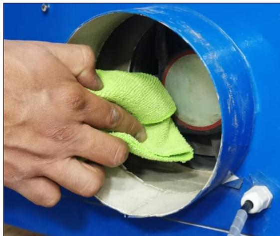
4. Volver a ubicar el tubo de extracción y continuar con el trabajo de la máquina.
