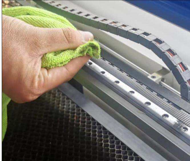
Se debe cuidar que después de la limpieza no queden residuos de pelusas del paño con el que se realizó la limpieza.
