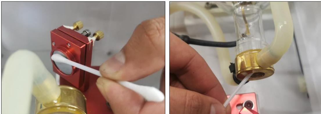
2. Con el otro extremo del hisopo (extremo seco), se seca el espejo de la misma manera, haciendo movimientos circulares.
