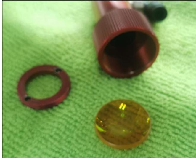
Con la ayuda de una pinza e incrustando las puntas en las dos ranuras circulares, remover la tuerca interna de adentro del cabezal que permite la salida del lente.
