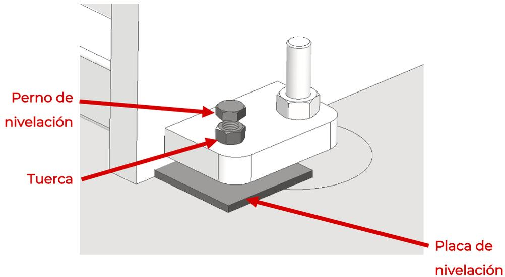
Se debe ir comprobando con una herramienta de nivel a cada extremo, que la máquina quede completamente plana para que el proceso de doblado no se vea afectado en la producción.
