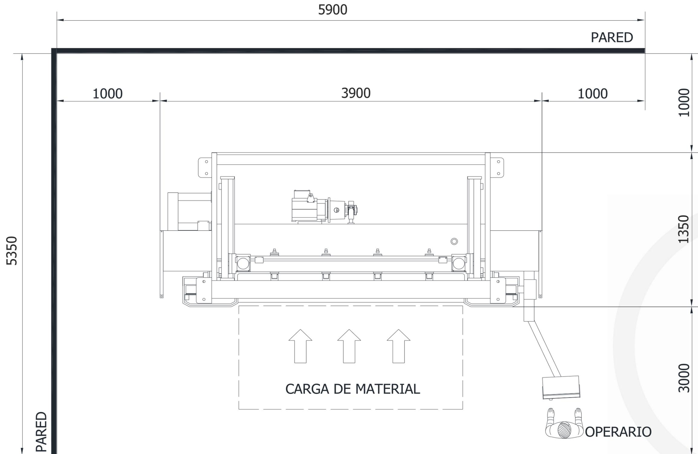
**3. Montaje de la máquina en suelo**
