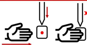
Sistema de seguridad a través de bloqueo por láser, cuando la máquina esté en proceso de doblado, un sensor láser detecta si la mano del operario ingresa y en seguida bloquea el proceso, asegurando el bienestar del operario y de la máquina.
