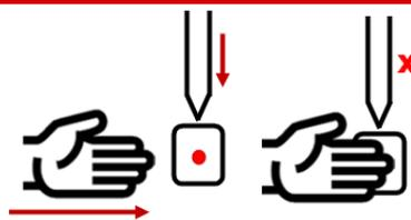
Sistema de seguridad a través de bloqueo por láser, cuando la máquina esté en proceso de doblado, un sensor láser detecta si la mano del operario ingresa y en seguida bloquea el proceso, asegurando el bienestar del operario y de la máquina.
