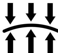
El eje V permite compensar la deflexión de la plancha automáticamente, lo que resulta en dobleces precisos y rectos a lo largo de toda la pieza.
