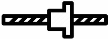
El movimiento del husillo en el eje Z está dado por sistema de tornillo y bolas. El cual garantiza una alta precisión y repetibilidad en su trayectoria.
