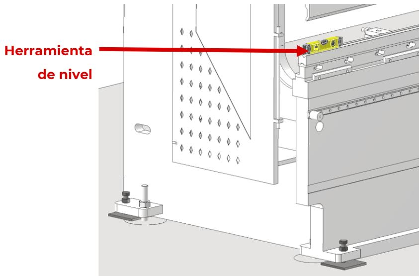
Si no está nivelada, se ajusta la tuerca del perno de nivelación en la esquina que se debe juntar más al suelo. De manera contraria, si una esquina se debe alejar más del suelo para nivelar la máquina, la tuerca debe quedar floja.
