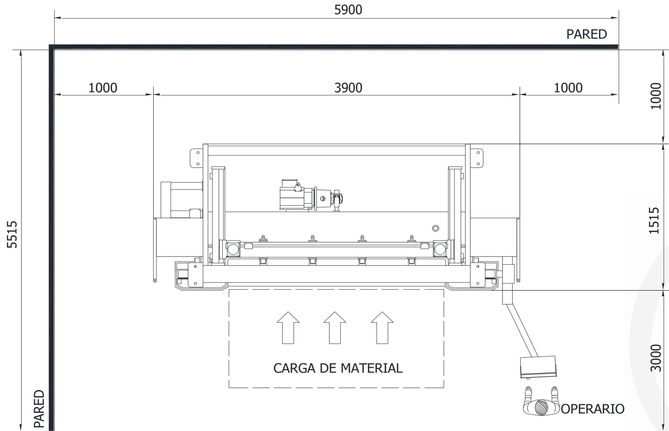
**3. Montaje de la máquina en suelo**
