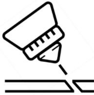
Incorpora dos ejes de control adicionales en el cabezal para realizar una gran variedad de cortes angulares (biselados) de hasta  $\pm 45^\circ$ .
