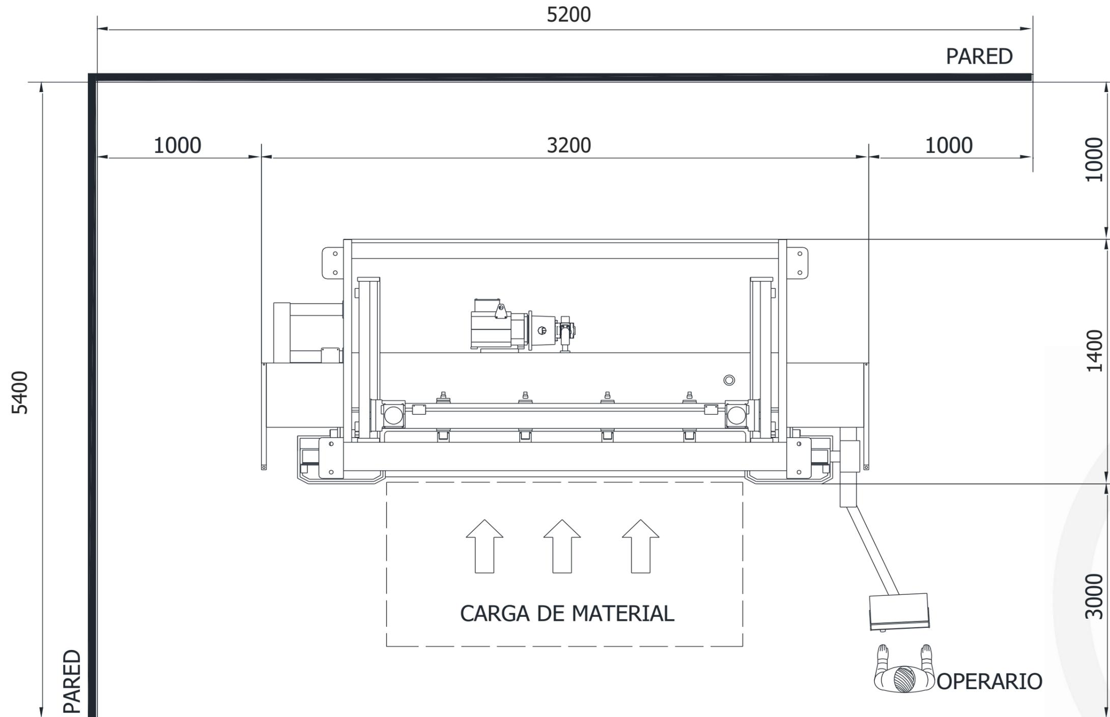
**3. Montaje de la máquina en suelo**
